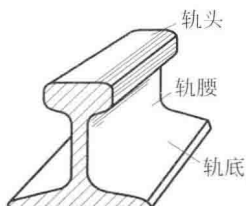
图 1-13 钢轨断面示意图
