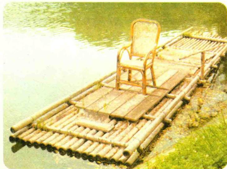
竹子加工好后，就可以进行组搭。先搞好支架，在上面排好加工好的竹子，一人在上，另一人在下，用藤条绑紧扎牢，竹筏就制成了。
