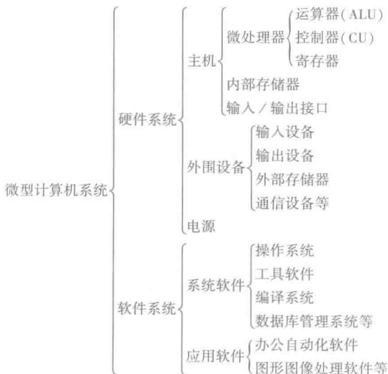
图 1-2 微型计算机系统组成
