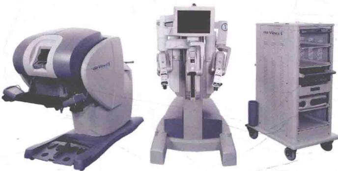
图1 达芬奇机器人手术系统的组成
