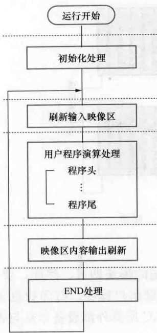
图 1-9 PLC 的控制过程
