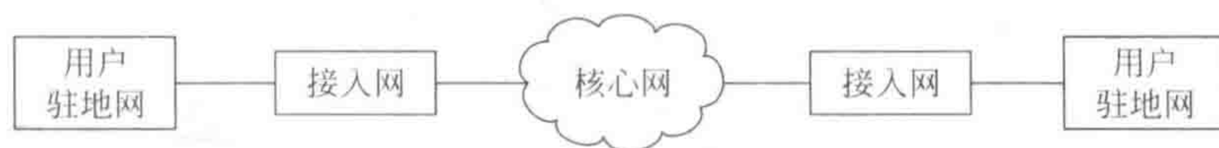
图 1-1 电信网的组成示意图
