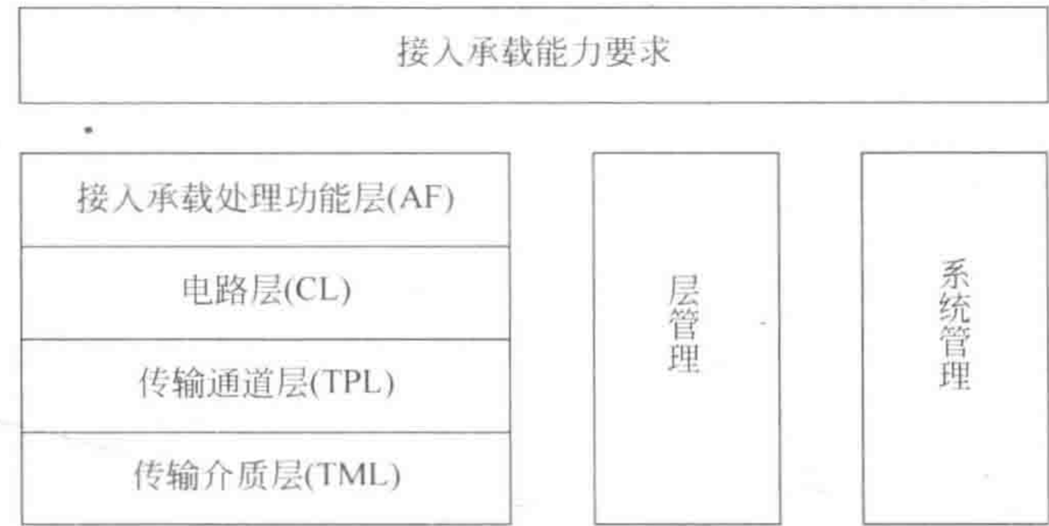
图 1-2 接入网的通用协议参考模型
