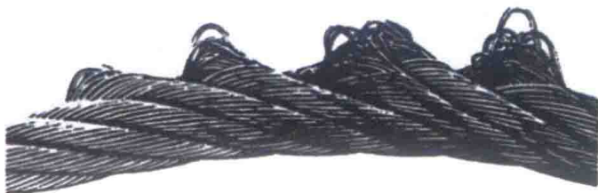
图1-11 钢丝绳磨损严重
