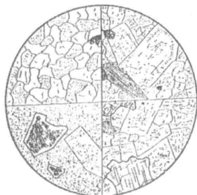
左上:等粒结构;左下:斑状结构; 右上:不等粒结构;右下:似斑状结构
