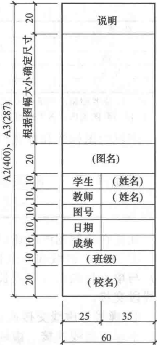
图 1-14 学生制图作业 用标题栏推荐 格式（单位：mm）
