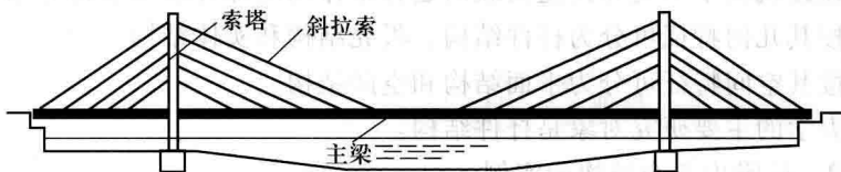
(d) 斜拉桥结构
