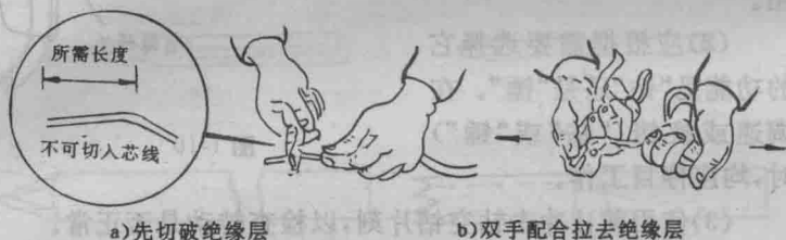
图 1-12 钢丝钳剥离绝缘层的方法
