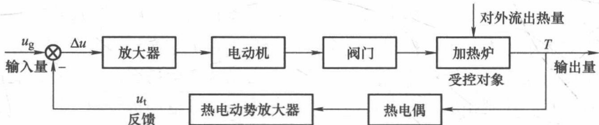
图 1-9 自动温度调节系统框图
