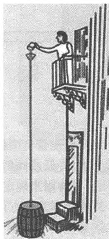
图 1.8 一杯水压破水桶实验
