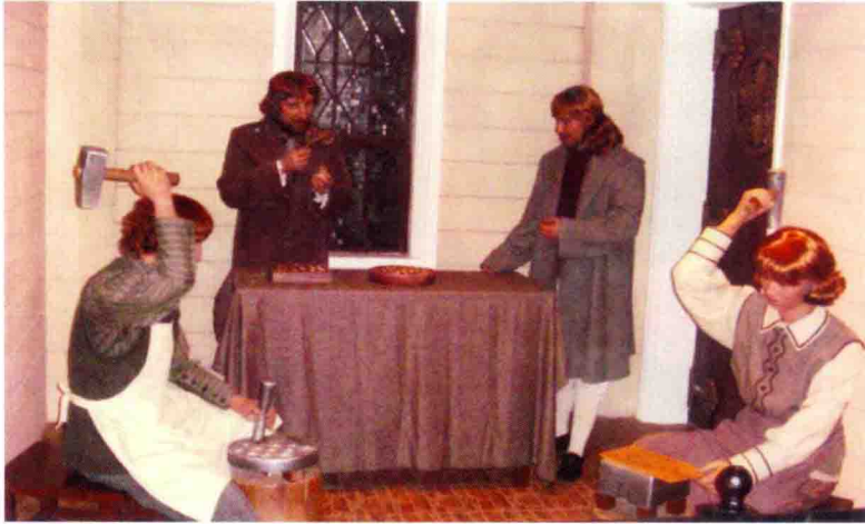
西方古代金属货币手工压造方法：将各材质毛坯加热，装入钢模锻造，冷却后稍加打磨，以备流通。
