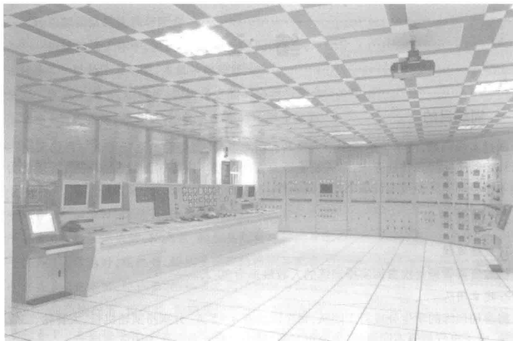
图 0-1 全任务轮机模拟器
