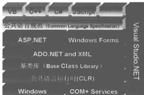
图 1-1 .NET Framework 体系结构图
