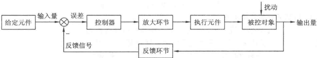
图 1.10 反馈控制系统的基本组成
