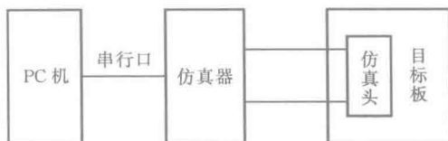
图 1.1 仿真器与PC机和目标板的连接
