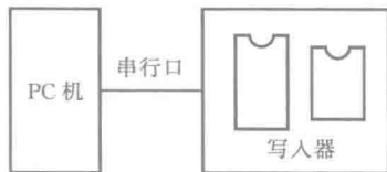
图 1.2 写入器与PC机的连接
