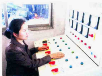
工人在操控熔炼炉
