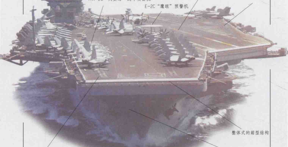
箱形的船体机构能承受很大的载荷，并可吸收中弹时的爆破能量
