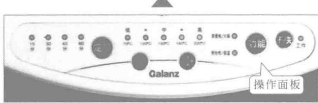
1 操作显示电路板是电磁炉中一块相对独立的电路板。主要是用于接收人工操作指令并送给主控电路板，由控制电路进行处理，再输出控制指令，如开/关机、火力设置、定时操作等，并通过指示灯、显示屏将电磁炉工作状态显示出来
