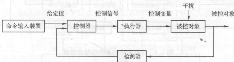
图 1.1 自动控制系统组成结构
