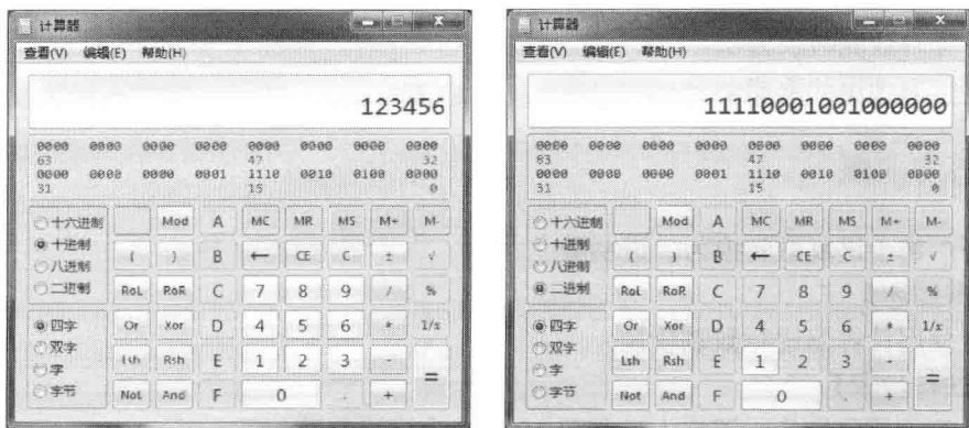
图 1-2 程序员计算器输入数值及转换后结果
