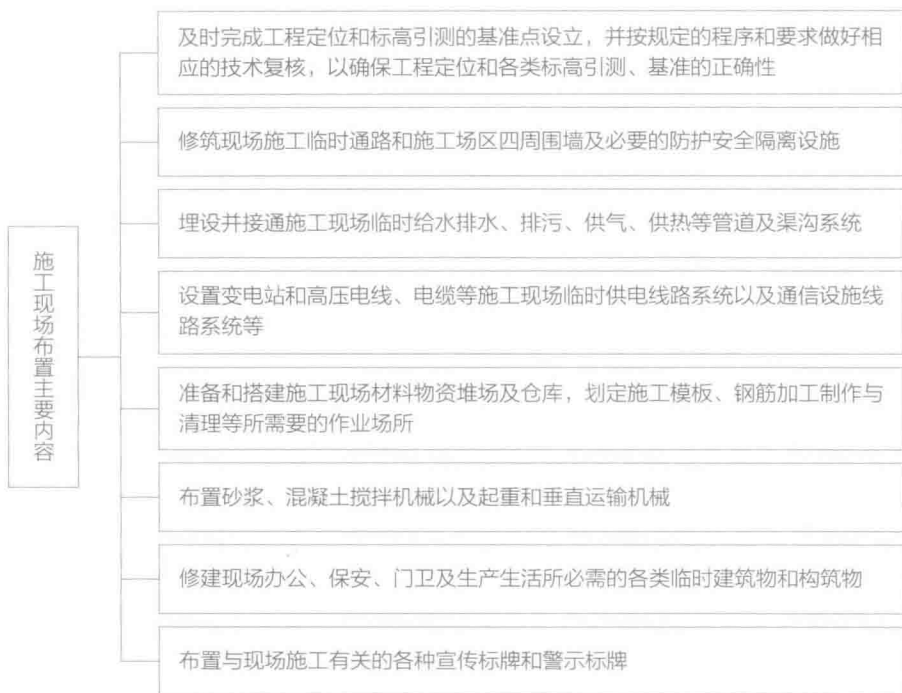
图 1-7 施工现场布置主要内容
