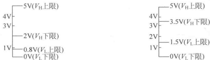
(a) TTL逻辑电路的高、低电平的电压范围 (b) CMOS逻辑电路的高、低电平的电压范围
