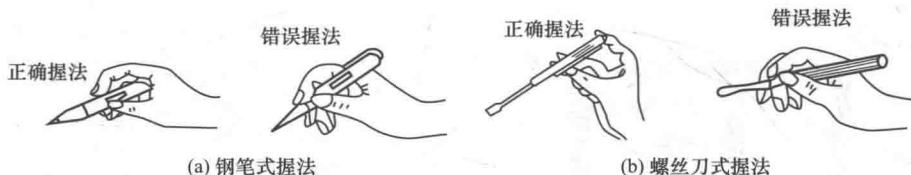
图 1-10 钢笔式和螺丝刀式试电笔的握法
