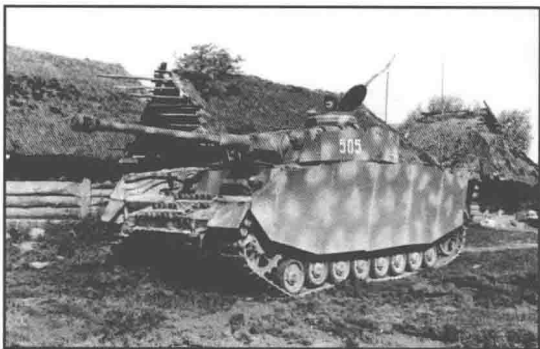
▲ 加装了侧裙板的 IV 号 H 型坦克。
