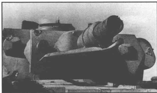
▲ IV 号 E 型坦克的炮塔，观察窗口已关闭。
