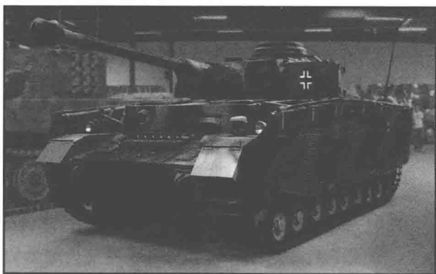
▲ 法国博物馆内 1 辆配备了炮塔裙边及金属丝网状侧裙的 IV 号 H 型坦克。
