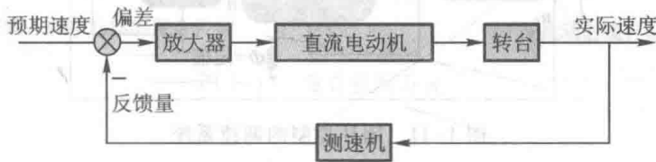
图 1-8 转台速度闭环控制系统方框图
