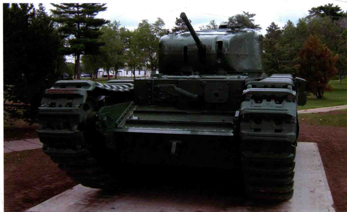
丘吉尔 MK I 型坦克，炮塔装有一门 QF 2 磅炮及贝莎同轴机枪，车头另装有一门 QF 3 英寸榴弹炮。
