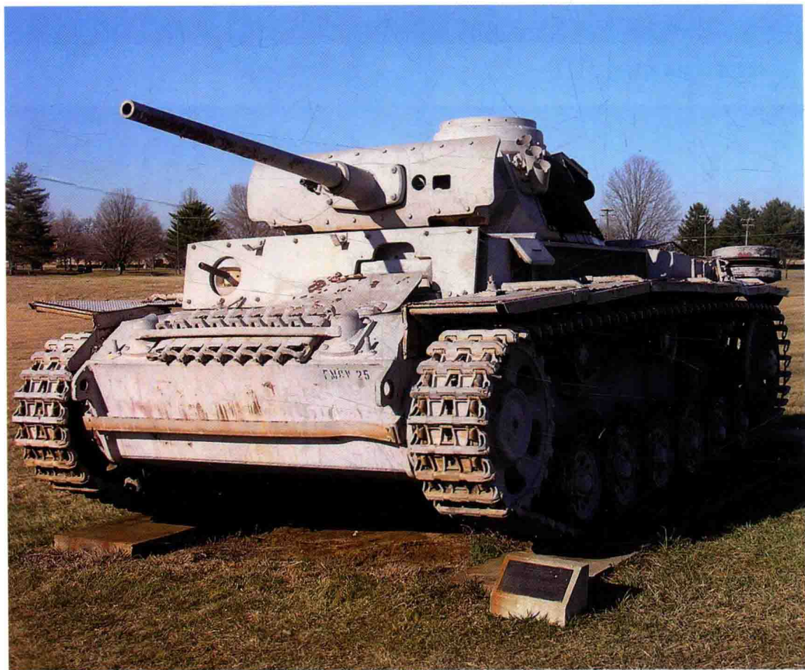
三号坦克，早期型号搭载一门 37 毫米主炮，后期有 50 毫米主炮型、75 毫米主炮型。
