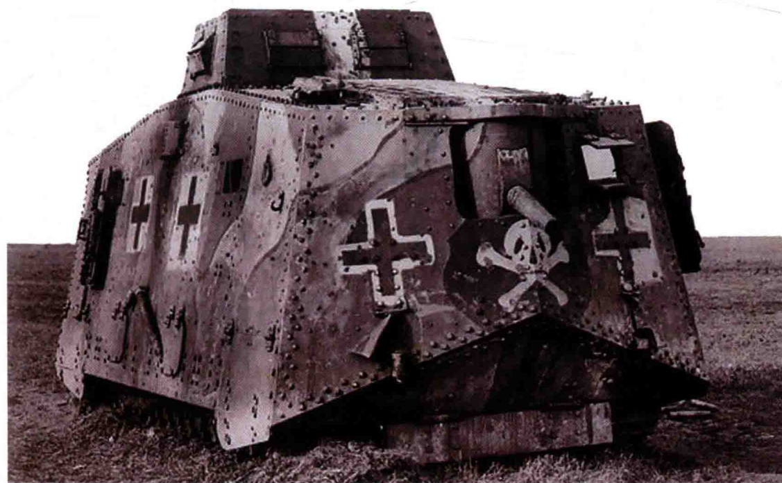
A7V坦克，全长7.34米，宽3.1米，高3.3米，搭载一门57毫米主炮和6挺7.92毫米机枪。1918年投入战场使用，到战争结束前仅生产了17辆。
