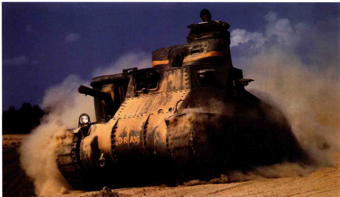
M3 中型坦克，美军在第二次世界大战早期使用的一款坦克，搭载的主要武器为一门 75 毫米主炮，此外还有 2 ~ 4 挺机枪。
