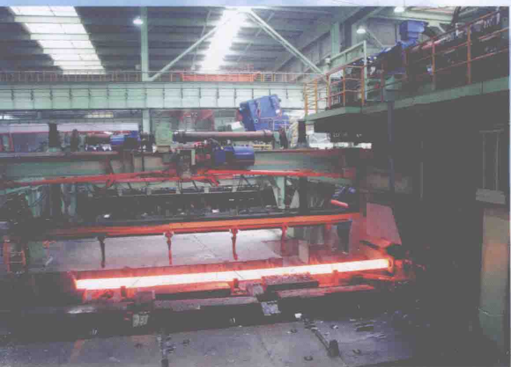
正在生产的直径 159 毫米无缝钢管生产线
