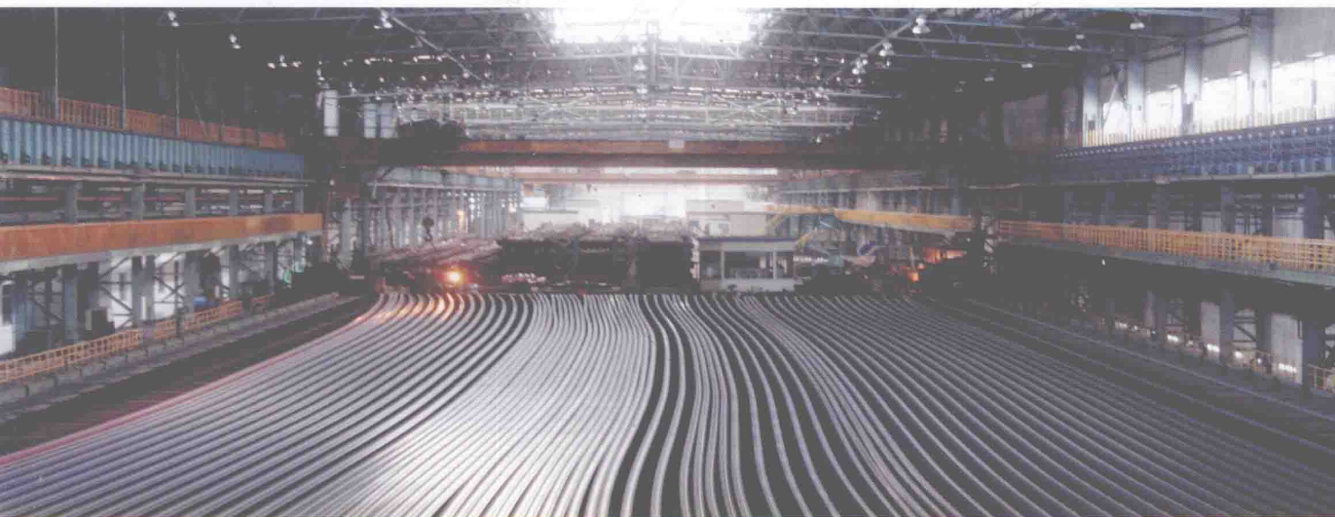
轨梁厂百米钢轨生产线
