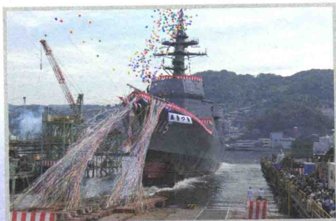
左图：2010年10月，新型19DD型驱逐舰的首舰“秋月”号（DD-115）下水。它的满载排水量接近7 000吨，装备了多功能雷达，用于支援4个护卫队群中的宙斯盾驱逐舰。（日本海上自卫队供图）
