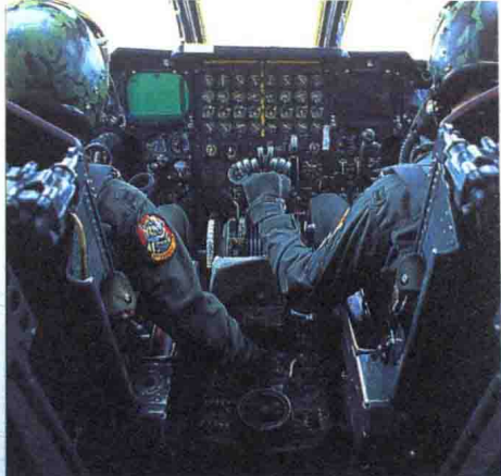
上图：B-52的座舱。发动机由中央控制板控制。每个发动机仪表盘和控制杆都被乘以8，因为有8台发动机。
