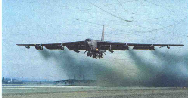
上图：B-52拥有巨大的机翼。起飞时，8台涡轮喷气发动机全力运转，使重达229 000千克（504 860磅）的飞机飞离地面，在升空时留下重重的浓烟。
