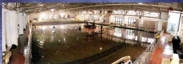
港珠澳大桥岛隧工程沉管定位和沉放实验
