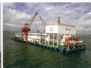
200m³/h混凝土搅拌船
