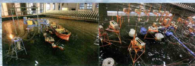
珠海LNG项目码头工程船舶系靠泊实验
