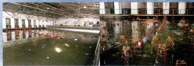
韩国Gamcheon Port工程波浪实验
