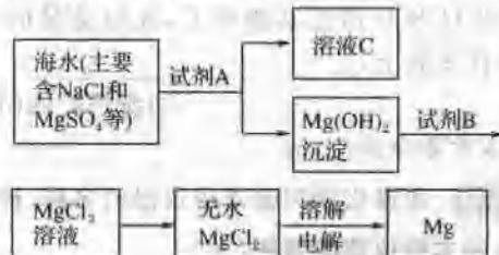
①上述用海水提取镁的步骤中，试剂 A 选用\_\_\_\_\_，试剂 B 选用\_\_\_\_\_。
