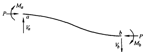
图 1-3 静力平衡条件
