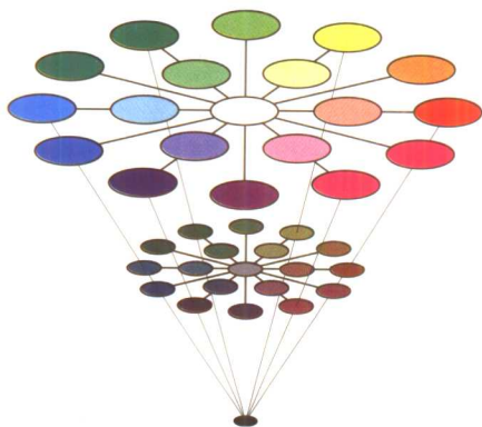
彩图 XVII HSV 颜色空间。色调围绕圆环变化，饱和度随半径变化，值随着高度变化
