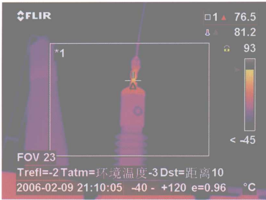
彩图8 330kV1号电抗器C相中性点桩头接线板发热热像图
