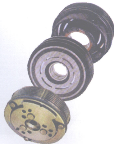
固定线圈式离合器实物
