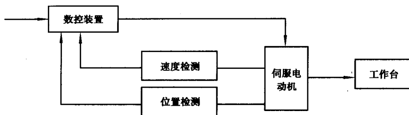
图 1.7 半闭环控制方式
