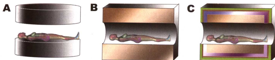
图1-1-2 左图为永磁型磁体，中图为常导型磁体，右图为超导型磁体。超导型磁体的通电线圈位于液氮所形成的超低温环境中，一般可以产生较高强度的磁场环境 ( >1.0T )。目前，中国医院普遍使用的为永磁型与超导型 MRI 机
