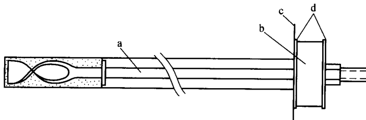
图 1-2-3 杆体可伸孔口可缩式拉伸锚杆
