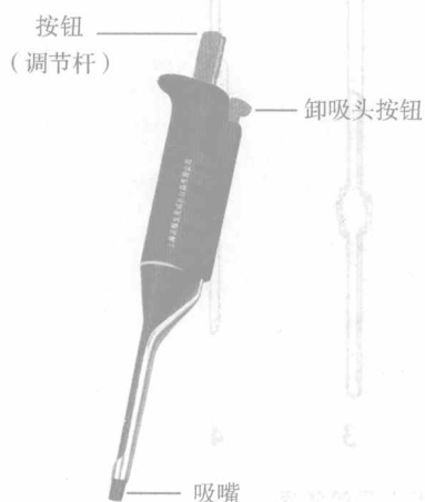
图 1-2-3 可调式移液器的结构
