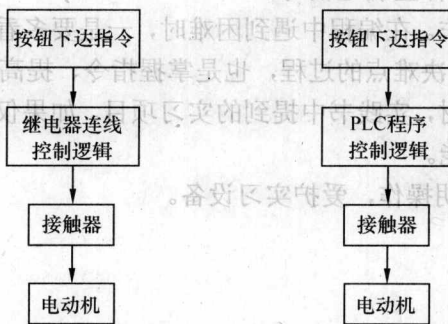
(a) 继电器电气控制系统 (b) PLC 电气控制系统
