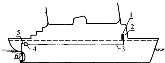
图 1-3 舵设备的组成 1—操舵器;2—舵角指示器;3—传动装置; 4—舵机;5—转舵机构;6—舵
