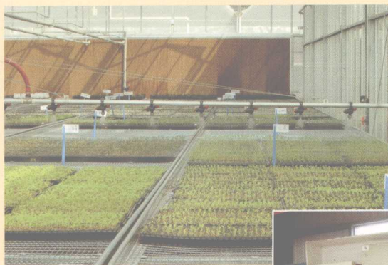
温室工厂化育苗 移动喷灌系统
