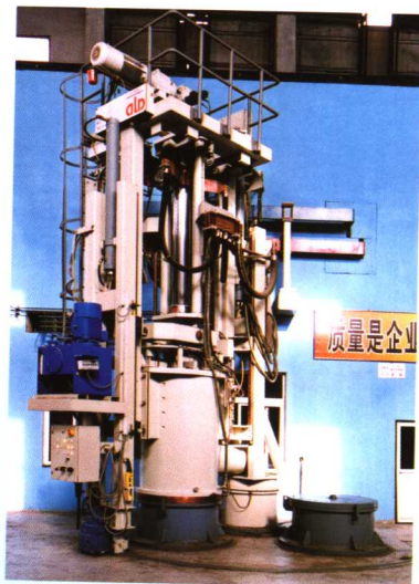
12吨真空自耗炉
