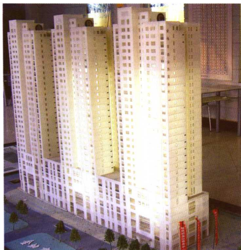
图 1-19 塑料模型之一:ABS 模型
