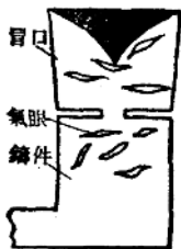
圖4 因隔片發生氣體而造成的廢品。
