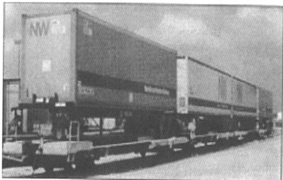
图 1-8 铁路驼背运输方式
