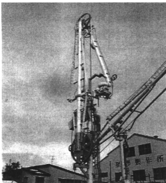
图 2-2 旋转平衡型卸料臂
