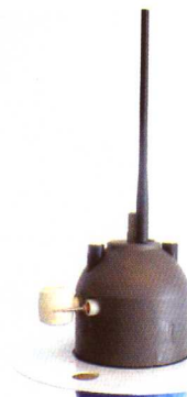
图 2-6 安装 FSI CTD 传感器的上端盖
